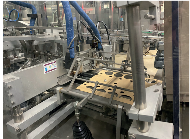
Die 10er-Lochsteigen werden parallel zum Packprozess vollautomatisch hergestellt.
