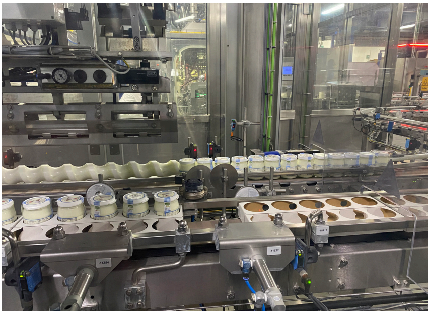
Die projektierte Stundenleistung des Packers, des Aufrichters und des Palettierers liegt jeweils bei mindestens 1.000 Steigen. Zusammen mit der nahezu baugleichen Linie 1 wird der Milchhof Sterzing künftig bis zu 20.000 Gläser pro Stunden einpacken und palettieren können.
